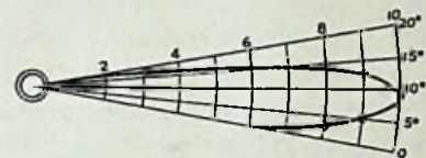
Fig. 5. Het verticale stralingsdiagram van een ruit-antenne.
